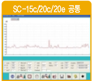
6가지의 실시간 측정값중 1as SPL 값만 선택하여 컴퓨터에서 모니터링하는 화면
