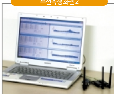
1대의 컴퓨터로 여러대의 소음측정기 (SC-160/30)를 무선으로 동시에 측정, 모니터링 하는 화면
